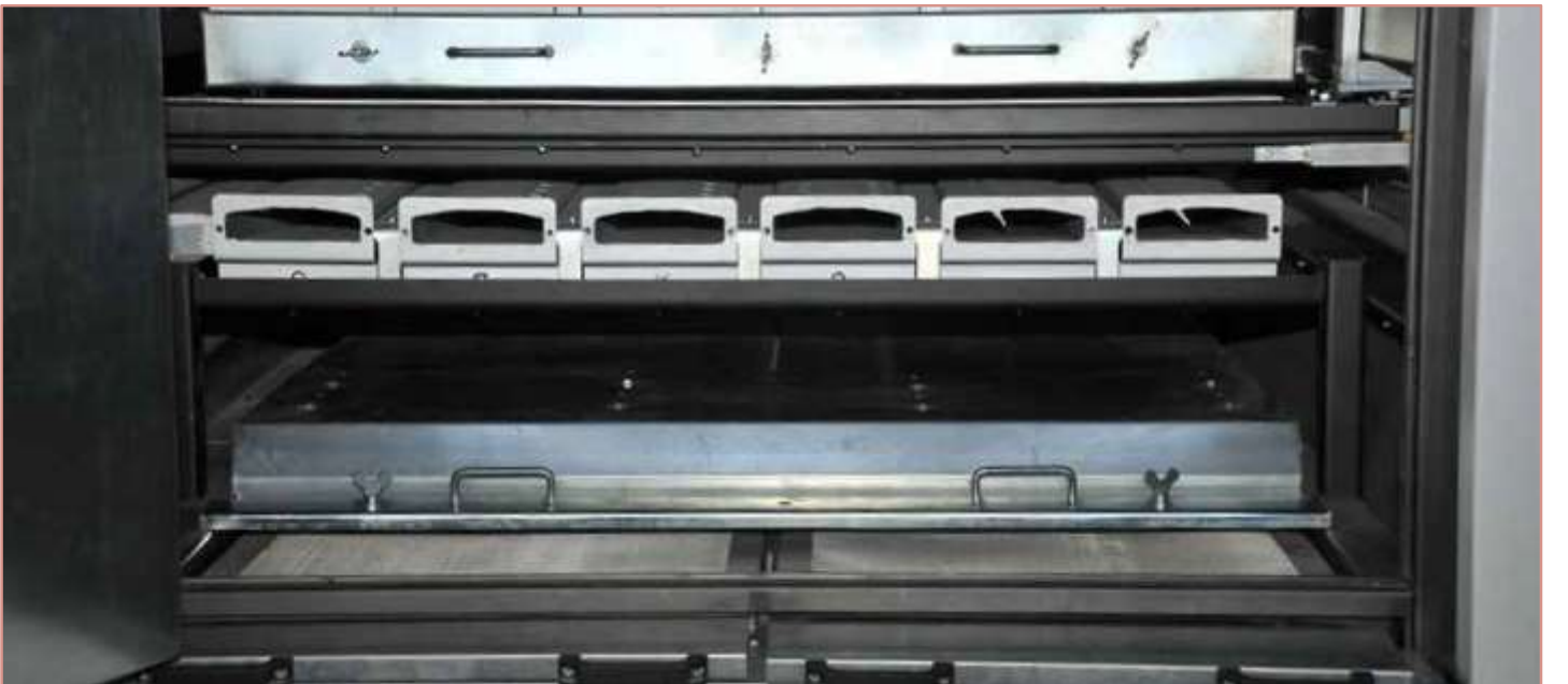
Uçları açılabilen hava kanalları ile kolay ve hızlı düze temizliği / Easy and quick self cleaning nozzle system
