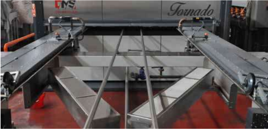
Giriş Bölümü / Fabric Entry Unit
