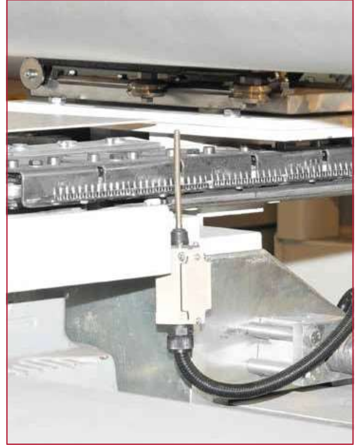
Kumaş İğne Çıkışı ve Alarm Swichi Exit Side Chain Safety Swichi
