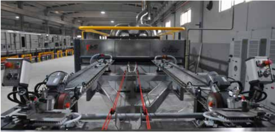
Giriş Bölümü / Fabric Entry Unit
