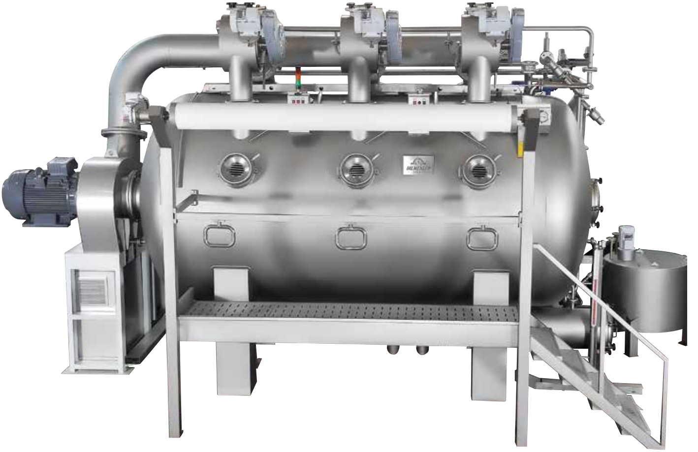
Akuple fan sistemi Direct coupled fan system
