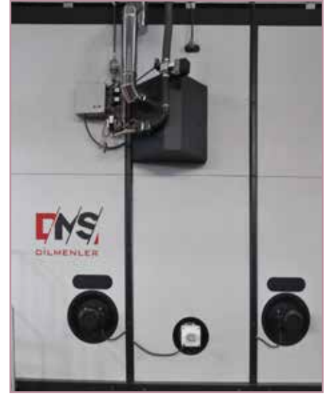
Sirkülasyon fanları ve brülör Circulation fans and burners
