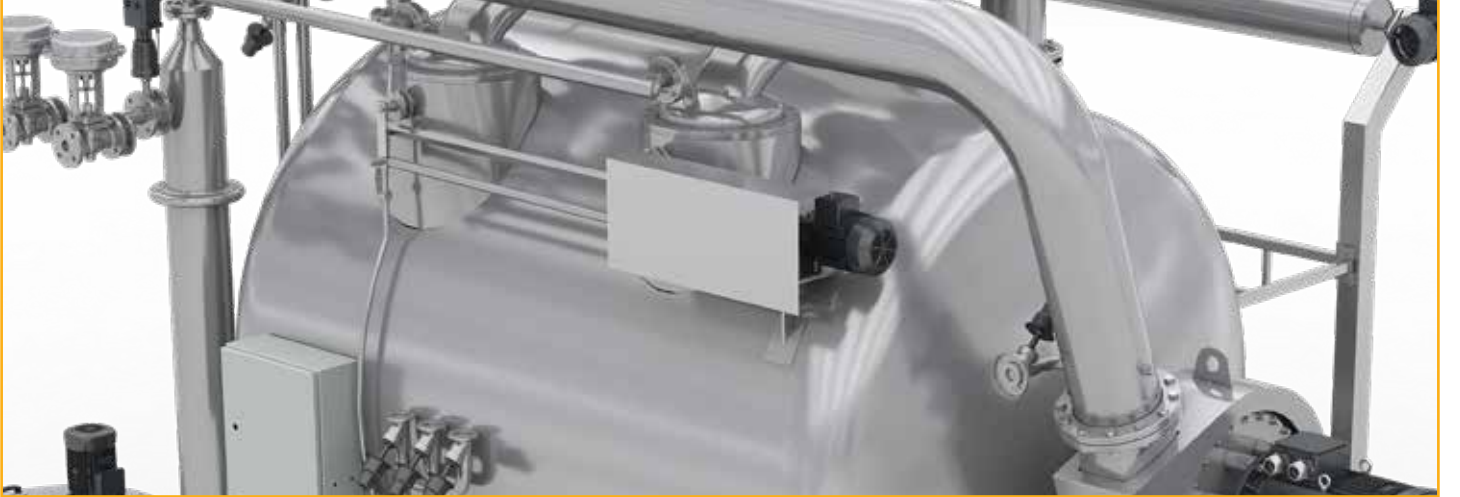
İstifleme karakteri ayarlanabilen kumaş dönme hızı ile senkronize çalışan sallama sistemi
